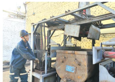
今年以来,阳煤集团二矿在修旧利废工作中,以契约化管理为抓手,树立全员成本意识,通过深挖内部潜力,规范员工操作技能,不断降低成本投入,增加企业效益。图为职工正在利用矿车整形机对矿车进行修复。任锁生 摄
